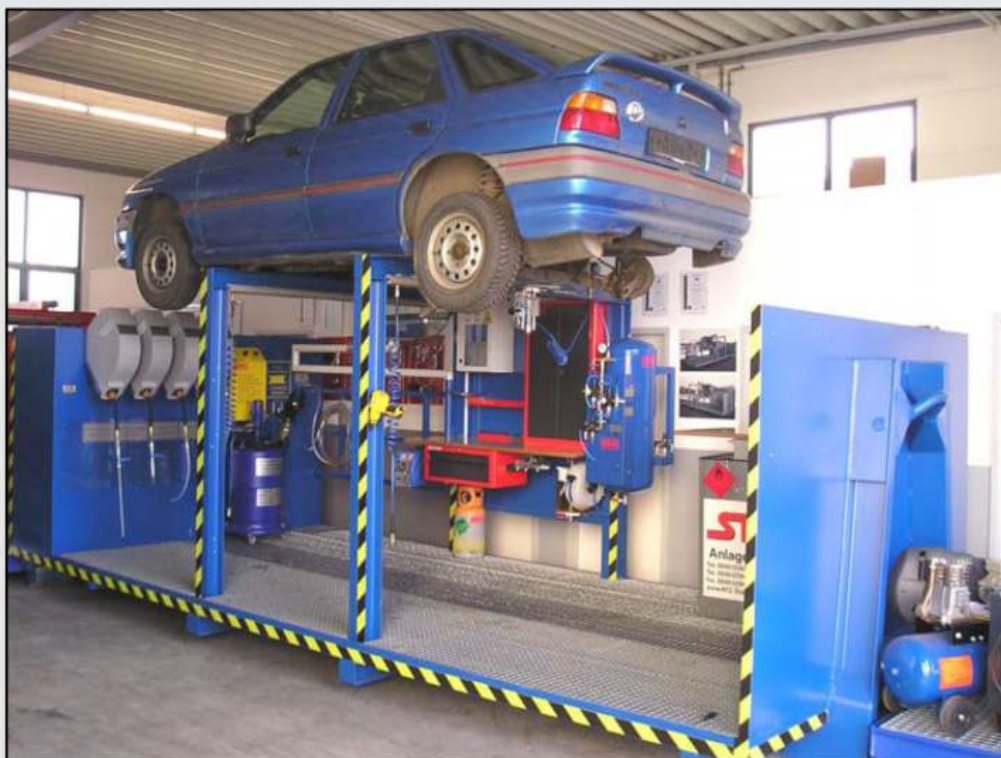
SZGK-Szárazra fektető mobil STH-003/E/10/H Bépitett folyadék tároló tartályokkal, a kompresszor opció
